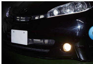
01 今回使用する車種は、TOYOTA WISHのフォグランプをハロゲンからHID仕様に変更する取付手順をご紹介します。
