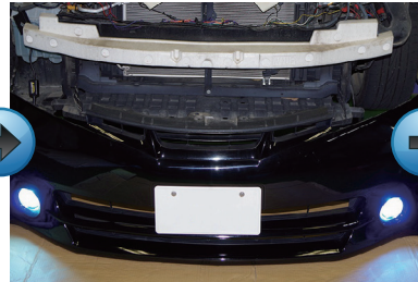
14 全て取付が完了したら、バンパーを戻す前に必ず点灯チェックをして下さい。
