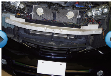
03 WISHの場合、フォグランプの取付の際、取付位置が狭い為、バンパーを一度外します。外した状態で、バンパーを置き、HIDを取り付けていきます。
