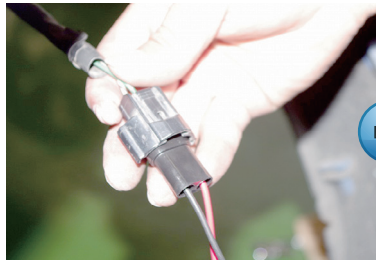
09 08で作成したカプラーを片方の車両側電源と接続いたします。今回のWISHは、バッテリーが助手席側にあるため助手席側からの車両電源を取りました。
