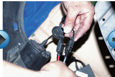
06 フォグランプユニットにHIDバーナーを差し込み、バーナーの配線を取り付けて行きます。
