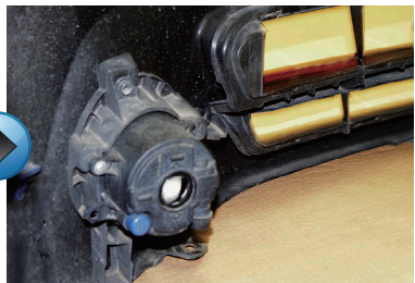
04 まず、フロントバンパーに付いている、純正のバルブを取り外します。
