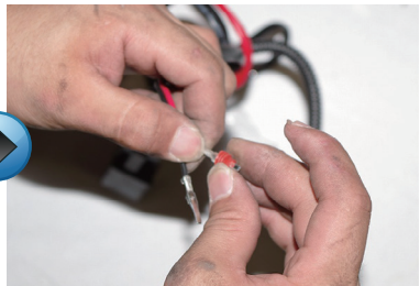
08 H11のキットには、付属で防水キャップが付いておりますのでこちらをご使用頂き、平端子ではなくカプラーオンにします。ゴムを取り付けた上でカプラー内に差し込んで下さい。
