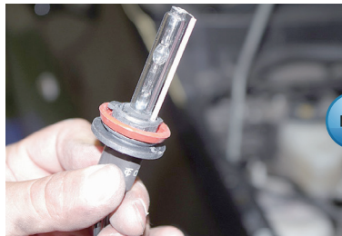
05 今回取付する、HIDバーナーを用意し、ユニット内に確実に差し込みます。この時、ゴムキャップを絵の用に一度めくっておいてください。
