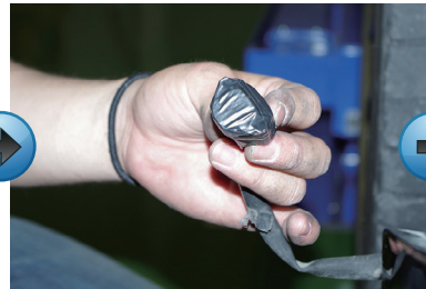
10 反対側(運転席側)の車両電源は使用しないので水等が侵入しないように防水処理を行います。防水処理は、ビニールテープ等で水が入らないように頑丈に巻いておきます。
